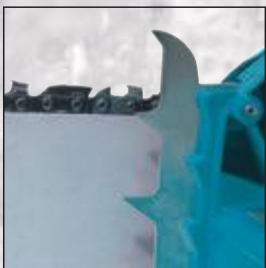
11. Velika metalna zupčasta letva Drži alat na miru kod veće produktivnosti.
