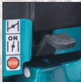
13. Touch&Stop sustav za upravljanje jednom ručicom Ima točno određene položaje ručice za hladno paljenje, rad i zaustavljanje uređaja.
