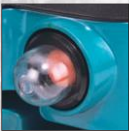
1. Ubrizgač Za jednostavnije paljenje hladnog uređaja.
